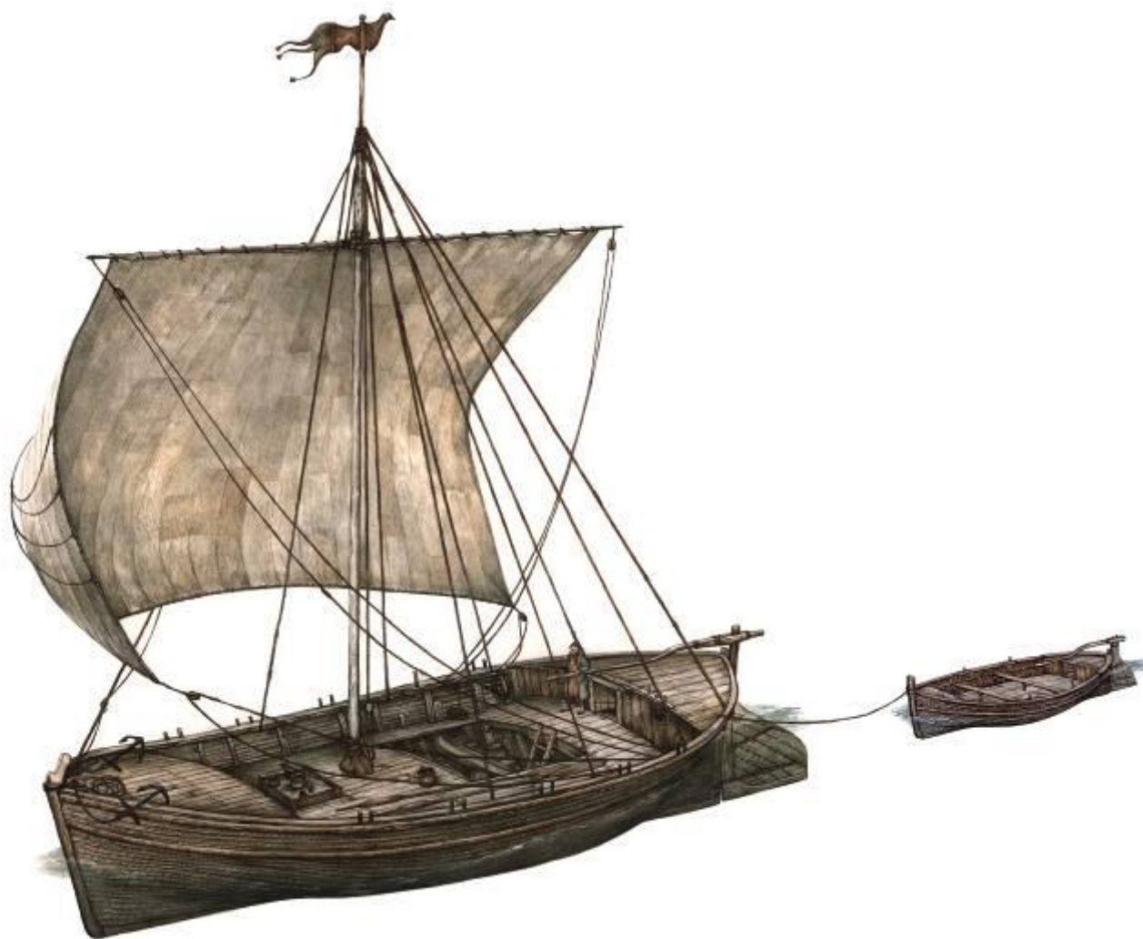
Рис. 146. Графическая реконструкция коча
