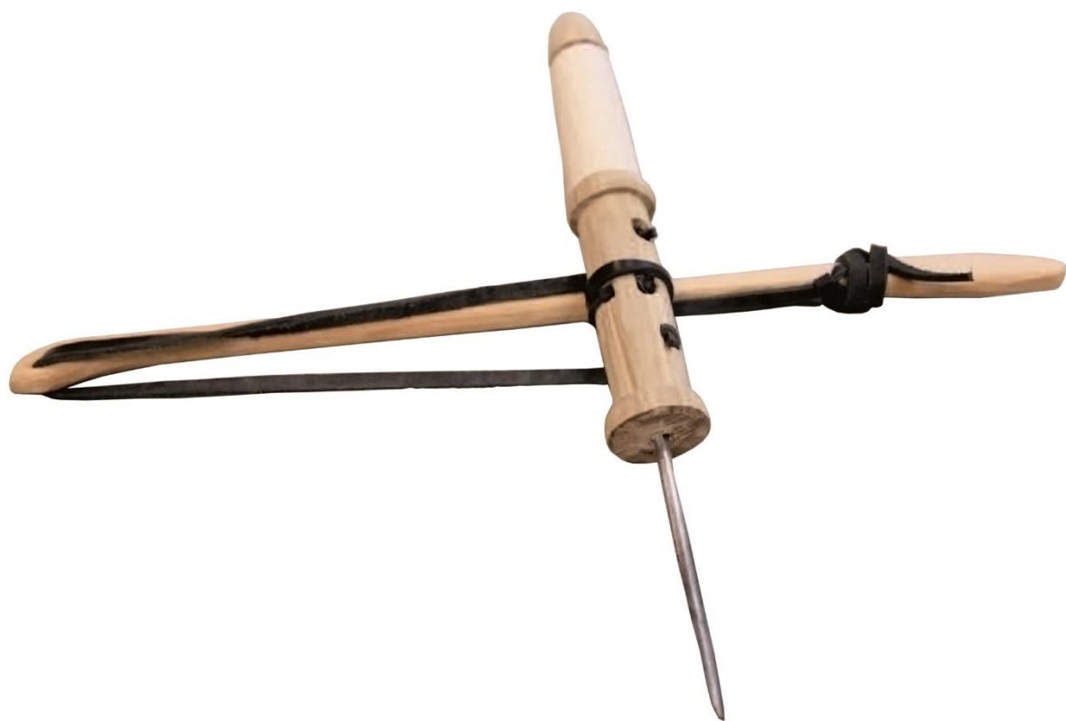
Рис. 116. Реконструированная лучковая дрель
