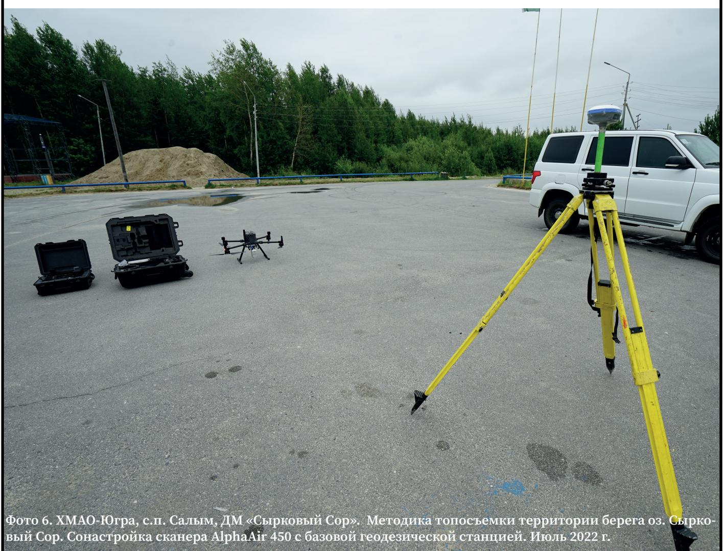
Фото 6. ХМАО-Югра, с.п. Салым, ДМ «Сырковский Сор». Методика топосъемки территории берега оз. Сырковский Сор. Сонастройка сканера AlphaAir 450 с базовой геодезической станцией. Июль 2022 г.
