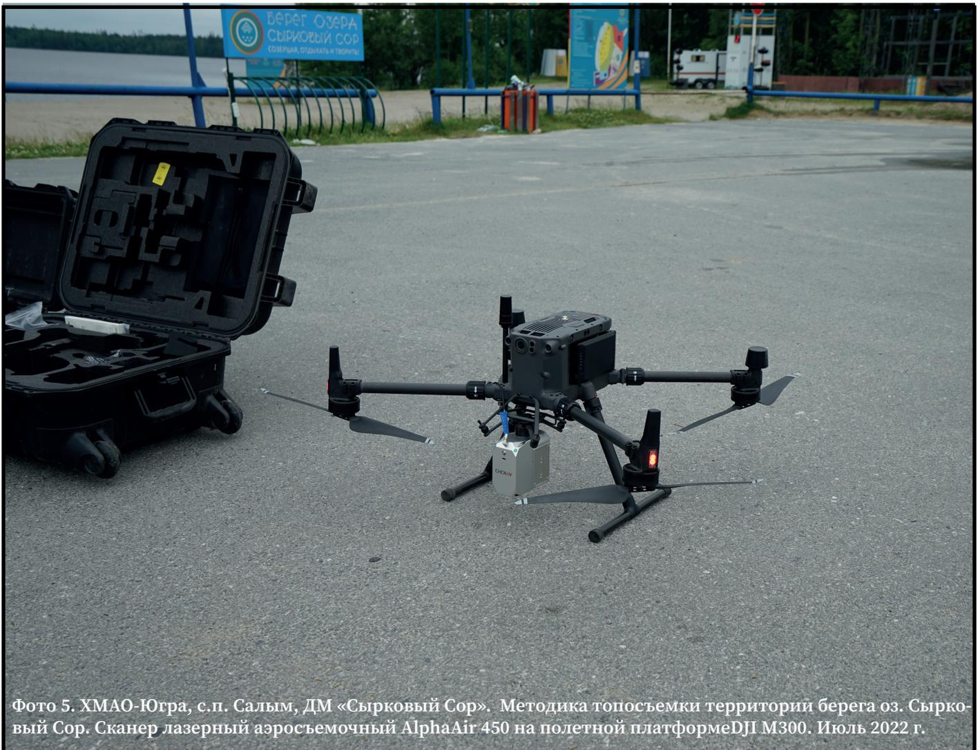
Фото 5. ХМАО-Югра, с.п. Салым, ДМ «Сырковский Сор». Методика топосъемки территории берега оз. Сырковский Сор. Сканер лазерный аэросъемочный AlphaAir 450 на полетной платформе DJI M300. Июль 2022 г.
