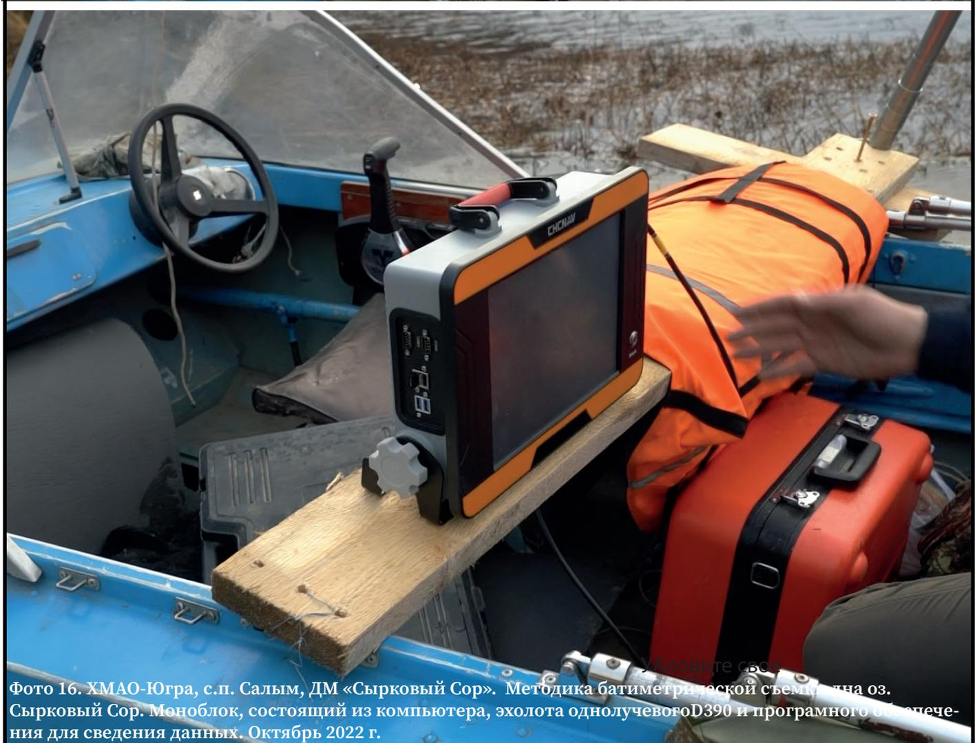
Фото 16. ХМАО-Югра, с.п. Салым, ДМ «Сырковый Сор». Методика батиметрической съемки дна оз. Сырковый Сор. Моноблок, состоящий из компьютера, эхолота однолучевого D390 и программного обеспечения для сведения данных. Октябрь 2022 г.
