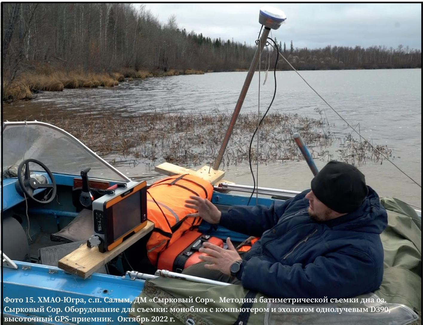
Фото 15. ХМАО-Югра, с.п. Салым, ДМ «Сырковый Сор». Методика батиметрической съемки дна оз. Сырковый Сор. Оборудование для съемки: моноблок с компьютером и эхолотом однолучевым D390, высоточный GPS-приемник. Октябрь 2022 г.
