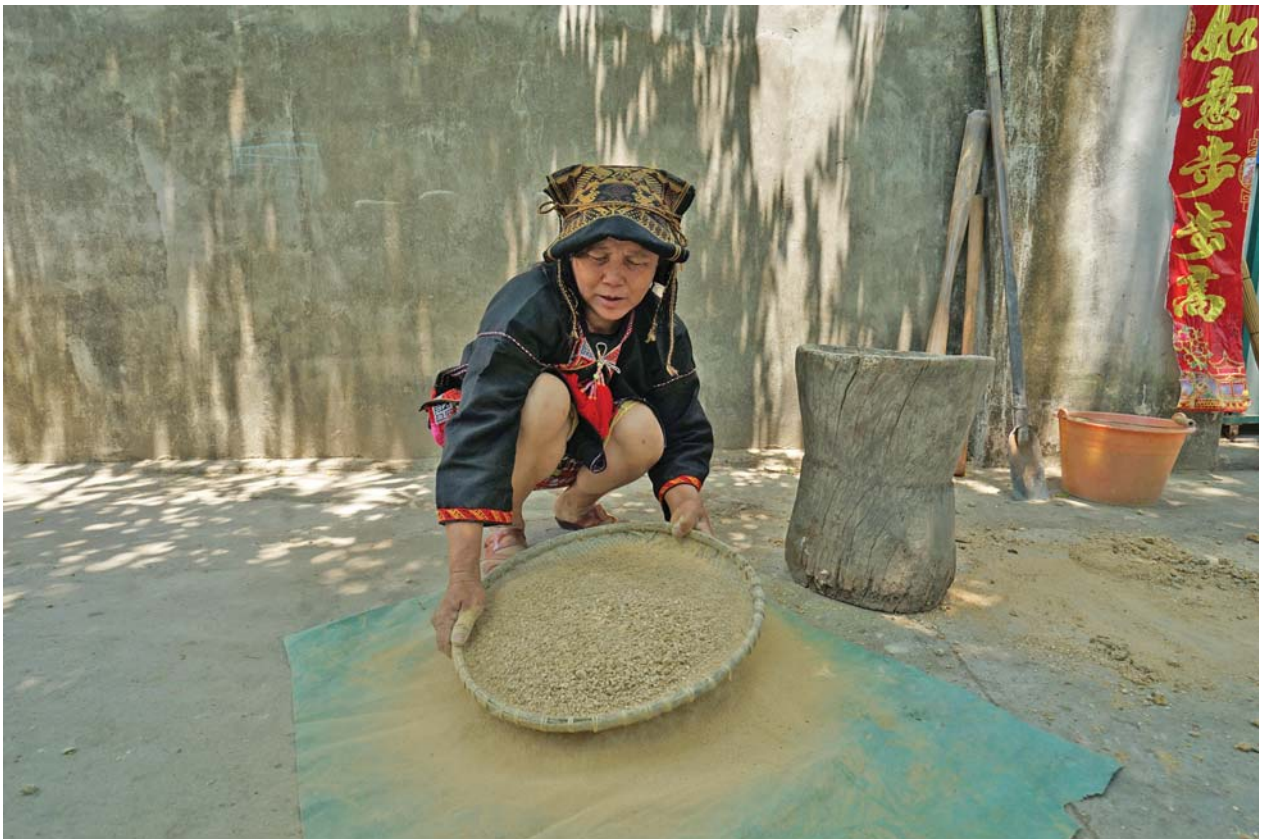
Рис. 2. Просеивание глины через самодельное бамбуковое сито. Фото О.В. Кардаша.
